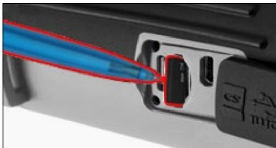
Для того, чтобы вынуть microSD-карту из слота, нажмите на нее, используя тот же тонкий предмет. Когда она выйдет из слота на несколько миллиметров, ее можно вынуть пальцами или пинцетом.
